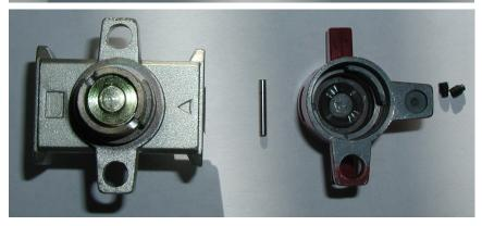
1. PUT SPRING CAP ON TOP OF THE SPRING HOUSED INSIDE THE VALVE BODY
